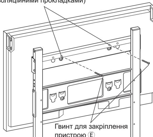
Гвинт для закріплення пристрою (E)
