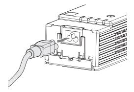
4) Pull out the connector of the power cord from the <AC IN> socket.
