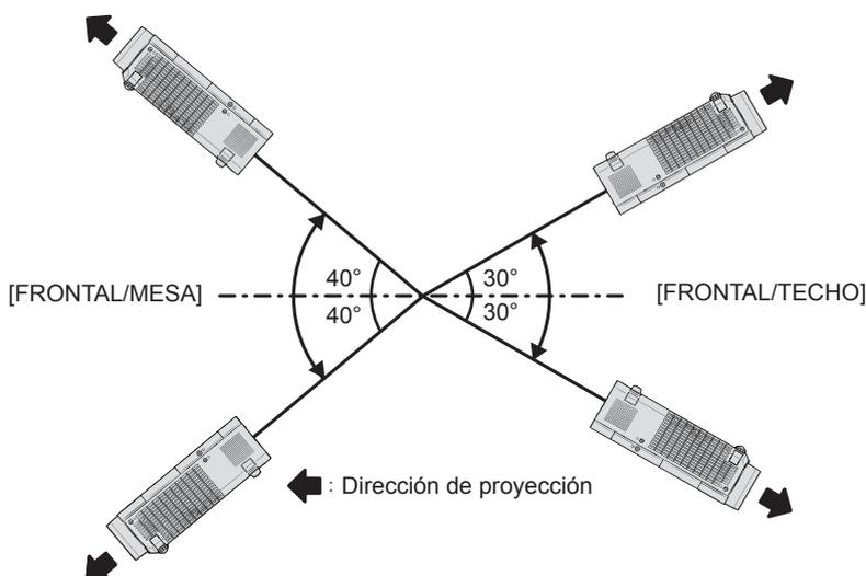
En el caso de [AUTO], se detectará como [FRONTAL/MESA] incluso aunque la inclinación esté inclinado más de  $\pm 40^\circ$  con la cara superior hacia arriba o más de  $\pm 30^\circ$  con la cara superior hacia abajo. Para utilizar el proyector inclinado más de  $\pm 30^\circ$  con la cara superior hacia abajo, configure el menú [SETUP PROYECTOR] → [MÉTODO DE PROYECCIÓN] con [FRONTAL/TECHO] o [RETRO/TECHO] en lugar de [AUTO].
