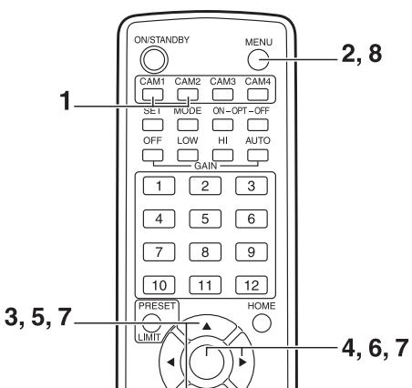
**1** Drücken Sie die Taste [CAM1] oder [CAM2], um das gewünschte Gerät auszuwählen.
