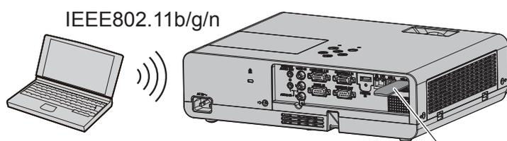
Беспроводной модуль из дополнительных принадлежностей (Модель №: ET-WML100)
