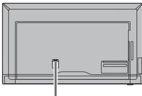
**Inserire il cavo CA correttamente sul lato posteriore dell'unità.**
