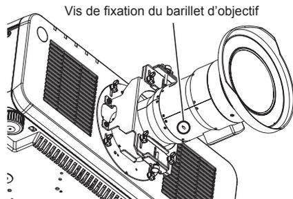
Vis de fixation du barillet d'objectif
