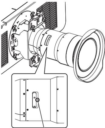
Vis de fixation du barillet d'objectif
