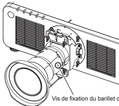
Vis de fixation du barillet d'objectif
