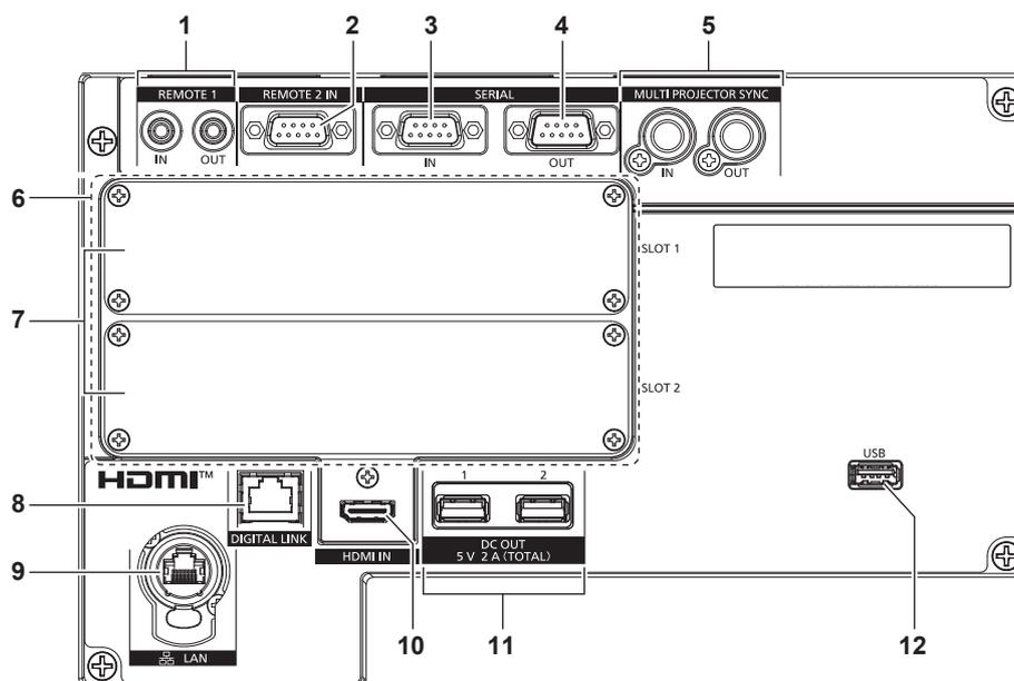
**1 <REMOTE 1 IN>-Anschluss/<REMOTE 1 OUT>-Anschluss**
