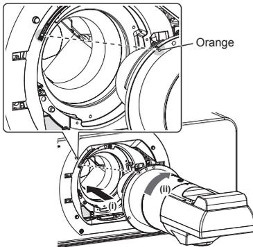
3) **Fixez l'objectif de projection à l'aide de la vis anti-chute de l'objectif incluse avec le projecteur.**
