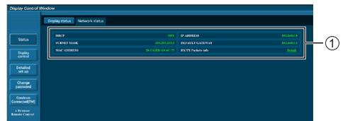
① Muestra los detalles de configuración de la red LAN cableada.
