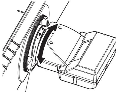
Baguette de réglage de la mise au point périphérique
