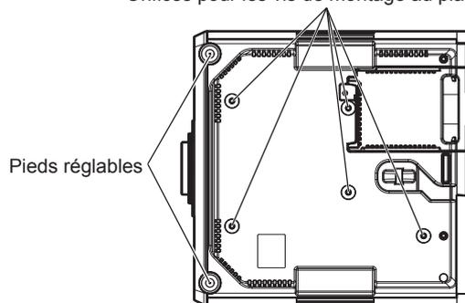
Positions des orifices pour les vis de montage au plafond et des pieds réglables
