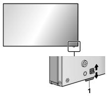
El indicador de alimentación y el sensor del mando a distancia se pueden sacar deslizando la palanca del panel posterior.
