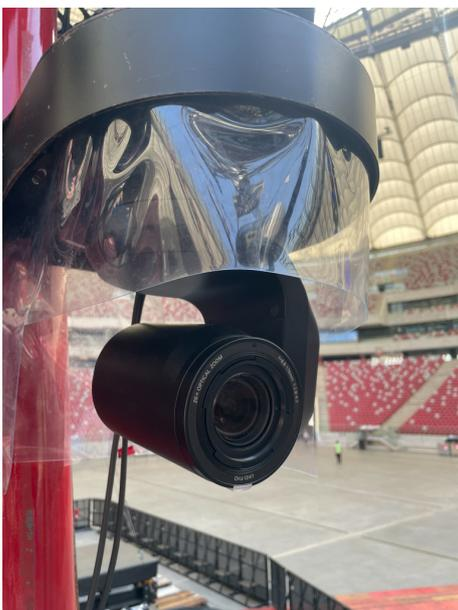
Die Kameras werden mit sieben der Panasonic AW-RP150 Fernbedienungen gesteuert, mit einem großen Touchscreen-Display für eine einfache Bedienung, einem Joystick für die Einhandbedienung und vereinfachten PTZ-Kamera-Presets und Tracing-Speicher. Das Team besteht aus sechs Operatoren, die von Tour Video System Engineer Bob Larkin und dem Video Director beaufsichtigt werden. Mit dem IP-basierten System mit Videosignal-Routing über SDI kann Bob schnell in jede Kamera eintauchen.
