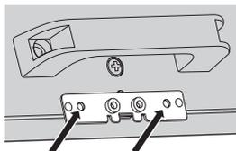
**3 Fissare il sensore al supporto.**
