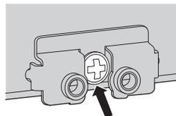
**3 Fissare il sensore al supporto.**
