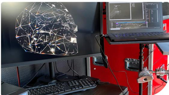
*Nate Cox, ingénieur chez BARTKRESA Studio, travaille sur deux écrans pour regarder simultanément le flux d'images de la caméra PTZ et le logiciel de projection mapping*
