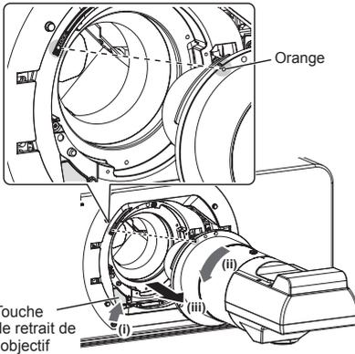
**3) Tournez l'objectif de projection dans le sens inverse des aiguilles d'une montre tout en appuyant sur la touche de retrait de l'objectif.**
