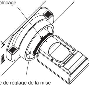
Bague de réglage de la mise au point périphérique
