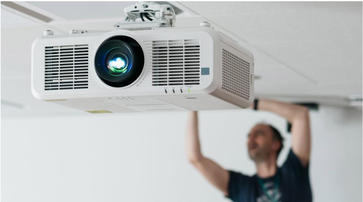
Die sechs Gruppenräume sind mit dem Panasonic 1-Chip DLP-Laserprojektor PT-RZ570 ausgestattet. Er bietet hohe Bildqualität mit 5400Lumen Helligkeit, WUXGA-Auflösung sowie einem Kontrastverhältnis von 20.000:1 und ist damit eine ideale Lösung für Bildungseinrichtungen. Die 360-Grad-Installationsoption und bis zu 20.000Stunden wartungsfreier Betrieb machen ihn zu einem flexiblen und zuverlässigen Gerät.
