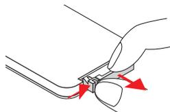
2) Installare la batteria nuova nel relativo vano.
