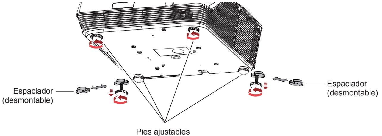
Quite el espaciador desmontable tirando de la parte convexa. Gire los pies ajustables traseros con el espaciador instalado. El intervalo ajustable es  $3,52^\circ$ . Al quitar el espaciador (desmontable), los pies traseros ajustables se encogen hasta el extremo y los pies ajustables delanteros se estiran hasta el extremo. El intervalo ajustable en dirección contraria es  $5,9^\circ$ .
