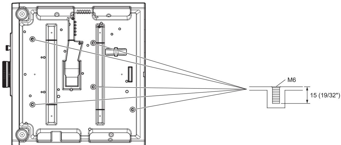
■ Размеры отверстий для винтов для крепления проектора (вид на нижнюю часть проектора)
