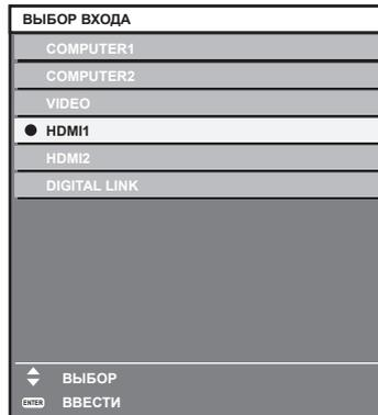
**2) С помощью кнопок ▲▼ выберите входной сигнал для проецирования, а затем нажмите кнопку <ENTER>.**
