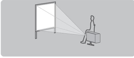
Установка в вертикальном положении и проецирование сзади (Использование полупрозрачного экрана)
