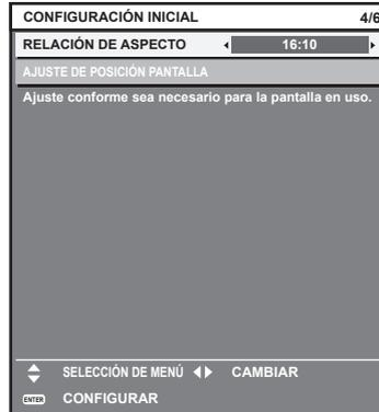
2) Pulse ▲▼ para seleccionar [AJUSTE DE POSICIÓN PANTALLA].
