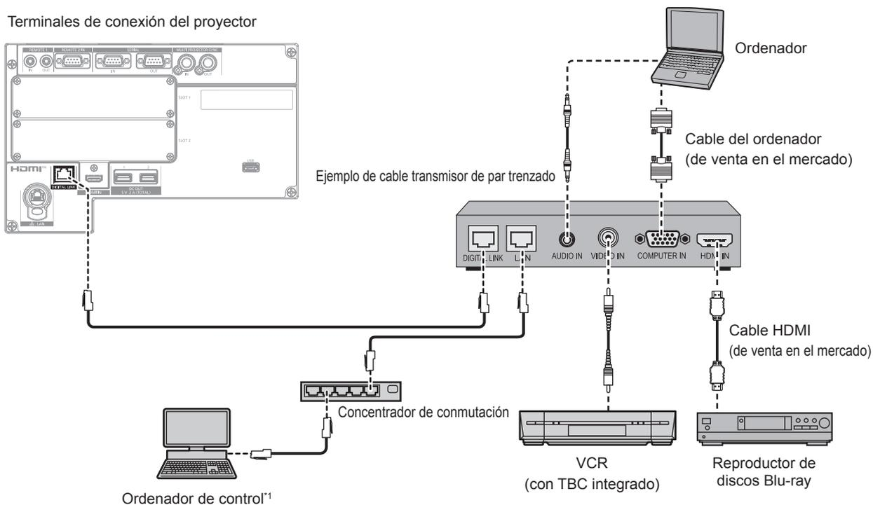
\*1 El objetivo del control es el proyector o el cable transmisor de par trenzado. El control automático no es posible según el cable transmisor de par trenzado. Compruebe las instrucciones de operación del dispositivo que se va a conectar.
