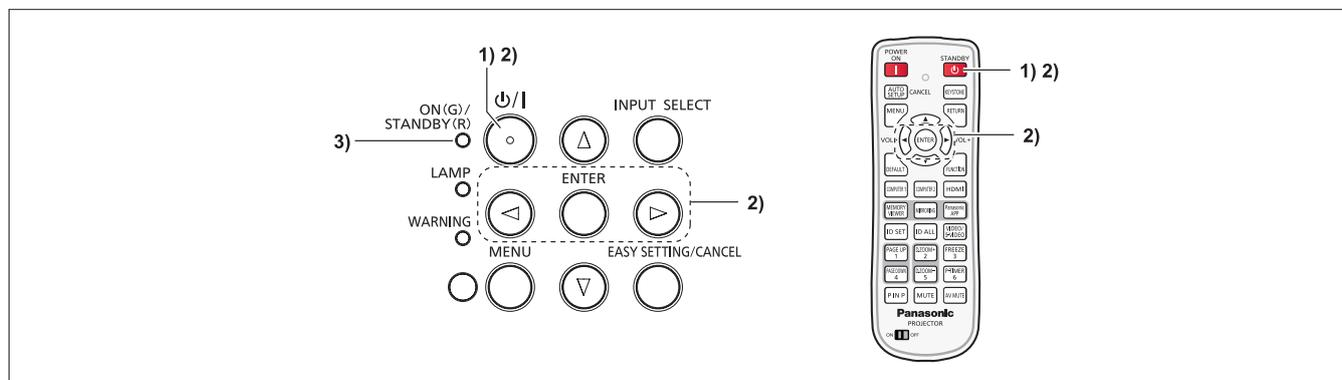
1) Appuyez sur la touche d'alimentation <ON/G/STANDBY(R)> sur le panneau de commande ou la touche Standby <ON> sur la télécommande.
