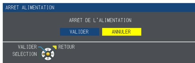
2) Appuyez sur <◀▶> pour sélectionner [VALIDER], puis appuyez sur la touche <ENTER>. (Ou appuyez sur la touche d'alimentation <ON/G/STANDBY(R)> sur le panneau de commande ou la touche Standby <ON> sur la télécommande de nouveau.)
