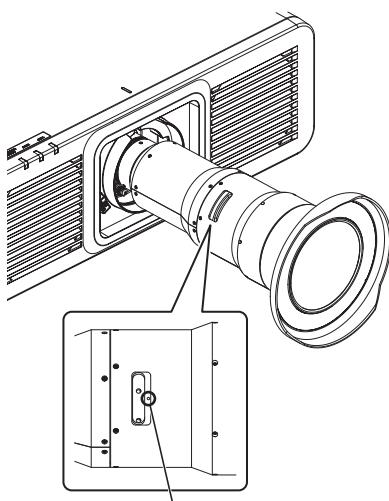
Vis de fixation du barilet de lentille
