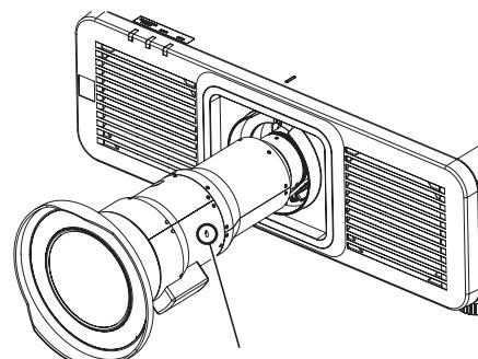
Vis de fixation du barilet de lentille
