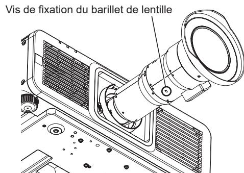
Vis de fixation du barilet de lentille
