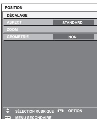
4) Appuyez sur les touches **▲▼** pour sélectionner un sous-menu, puis appuyez sur les touches **◀▶** ou la touche **<ENTER>** pour modifier ou ajuster les paramètres.
