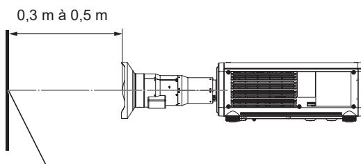
Position d'ajustement de la mise au point
