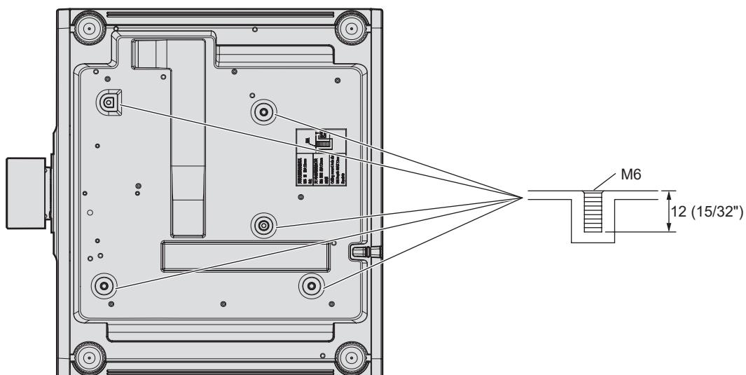
■ Dimensions des orifices pour vis pour fixer le projecteur (vue du dessous du projecteur)
