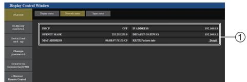
① Visualizza i dettagli di configurazione della LAN cablata.
