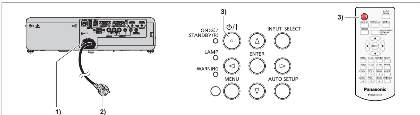
**1) Schließen Sie das Netzkabel an das Projektorgehäuse an.**
