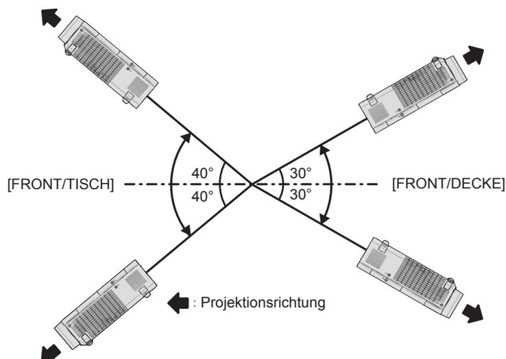
Im Modus [AUTO] wird dies als [FRONT/TISCH] erkannt, falls der Projektor mit der Oberseite nach oben über  $\pm 40^\circ$  oder mit der Oberseite nach unten über  $\pm 30^\circ$  geneigt ist. Wenn der Projektor mit über  $\pm 30^\circ$  mit der Oberseite nach unten geneigt ist, stellen Sie im Menü [PROJEKTOR EINST.] → [PROJEKTIONSARTEN] auf [FRONT/DECKE] oder [RÜCK/DECKE] anstelle von [AUTO] ein.
