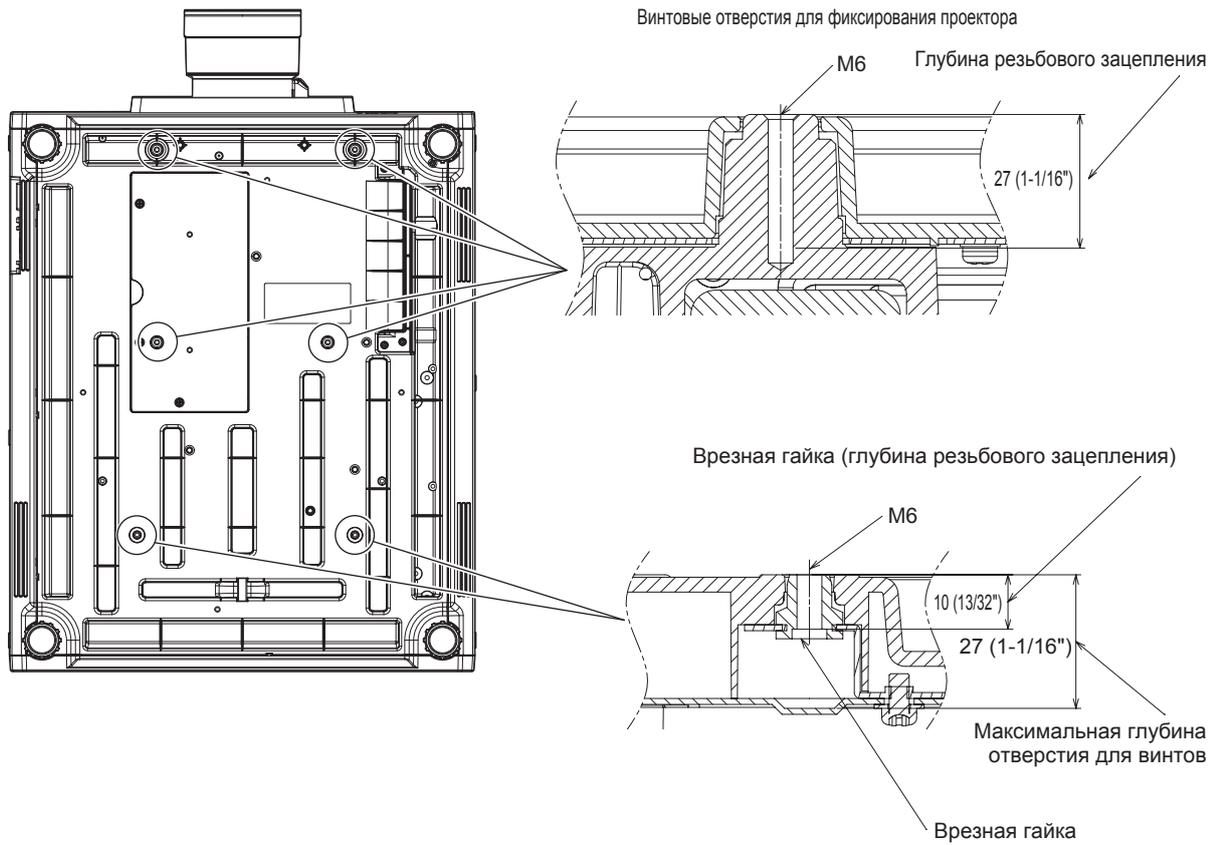
Момент затяжки винтов: (M6)  $4 \pm 0,5$  N·m
