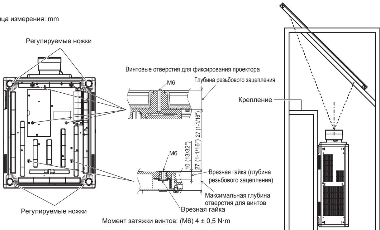
Момент затяжки винтов: (M6)  $4 \pm 0,5 \text{ N}\cdot\text{m}$
