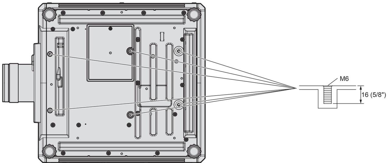
■ Dimensiones para los orificios roscados para fijar el proyector (vista inferior del proyector)
