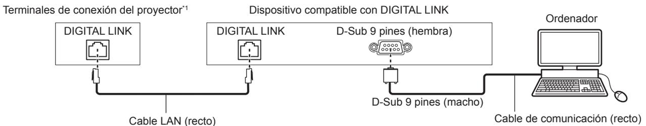
\*1 Cuando la Tarjeta de terminales DIGITAL LINK opcional (Núm. de modelo: TY-SB01DL) está instalada en la ranura
